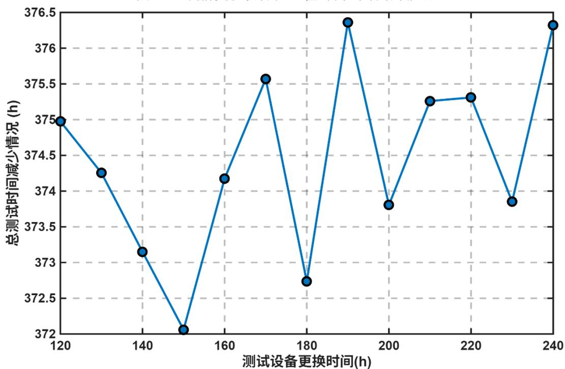
图 12 提前更换设备对测试时间的影响
